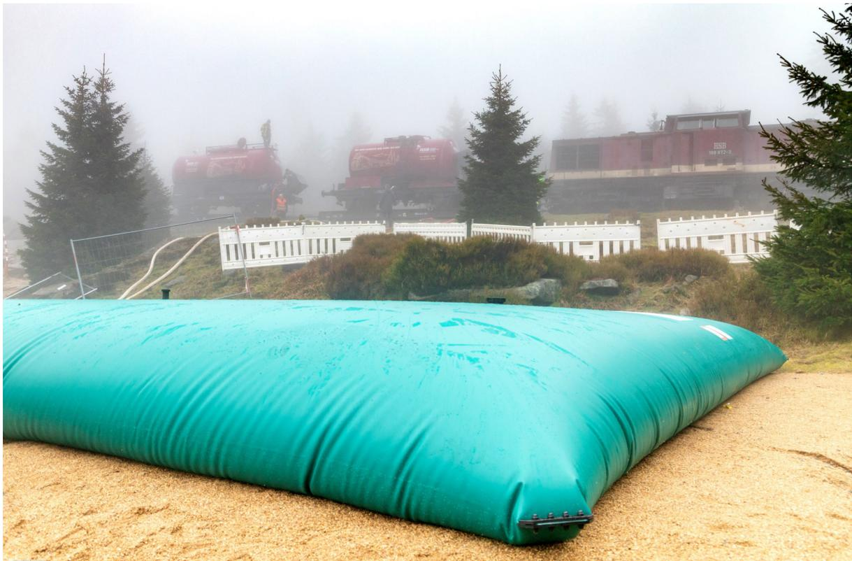
FOTO: Das faltbare Löschwasserkissen beim Bahnhof Goetheweg an der Brockenbahn am Königsberg wurde Anfang April von den Feuerwehren aus Wernigerode und Schierke mit Unterstützung der HSB befüllt.
